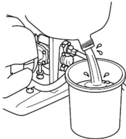
3. Instale la tapa de drenaje, extraiga la tapa del tanque de líquido e introduzca agua limpia en su interior
